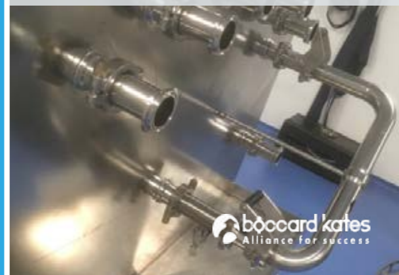
Modyfikacja panela transferowego na wersję z BocLock (użycie adapterów zaciskowych / BocLock), aby zachować oryginalny TP
